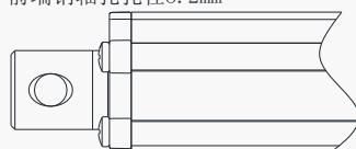
前端销轴孔孔径8.2mm
